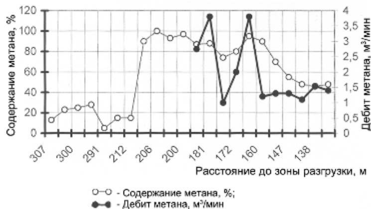
Рисунок 6 – Динамика дебита и содержания метана в скважине №7Э [4]
